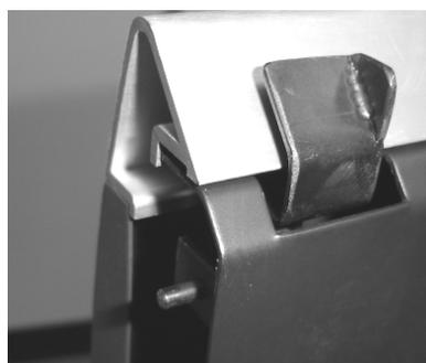
Les photos montrent les manettes en position verrouillée et déverrouillée. Le plateau est assez lourd et reste en équilibre stable en position relevée (environ 110°). Il est recommandé de ne pas laisser le scanner le plateau relevé.
