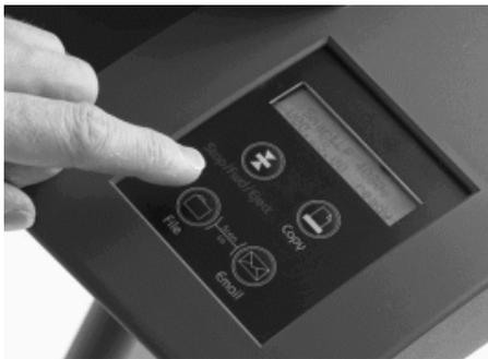
Vous pouvez maintenant mettre sous tension le SmartLF. L'écran de contrôle à cristaux liquides (LCD) s'allumera après quelques secondes et affichera le modèle de scanner et sa version de Firmware. Après avoir engagé un document, le message passera à READY.
