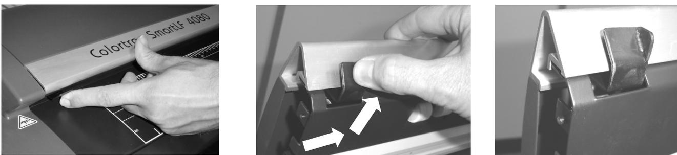
Pendant l'ouverture les manettes peuvent être verrouillées pour éviter d'endommager les montants du scanner lors de la fermeture. Mais il faudra se rappeler de débloquer ces manettes au moment de replacer le plateau en position basse. **NE PAS** essayer de baisser la hauteur du plateau quand les manettes sont en position verrouillée.
