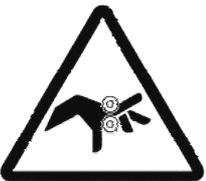
Ce symbole est destiné à alerter l'utilisateur sur l'existence de recommandations d'utilisation et de maintenance. Cet équipement peut lors de son fonctionnement entraîner les doigts de l'utilisateur dans le mécanisme et provoquer des blessures.
