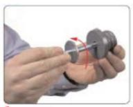
Dévisser l'écrou et le boulon des 2 embouts en plastique.
