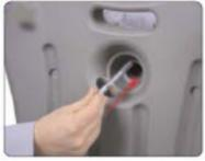
Visser les écrous et boulons sous la base pour fixer les pieds.
