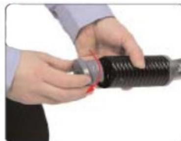
**2.** Visser les embouts en plastique dans les pieds en caoutchouc (silent-block) attachés au cadre.
