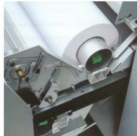
Alimentation automatique à partir d'une ou deux bobines de papier, calque ou polyester et "by-pass" pour alimentation manuelle en feuille à feuille.
