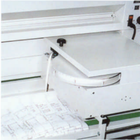
Option DIASTRIP pour la plieuse, permettant le collage automatique d'une bande d'archivage classeur sur le plan, après pliage.
