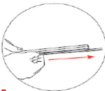
**5.** Faire glisser la glissière avec le visuel dans le rail supérieur. Resserrer les vis pour sécuriser le rail supérieur.
