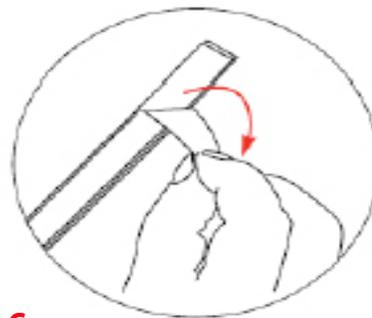
**6.** Fermer l'embout du rail en le faisant pivoter.
