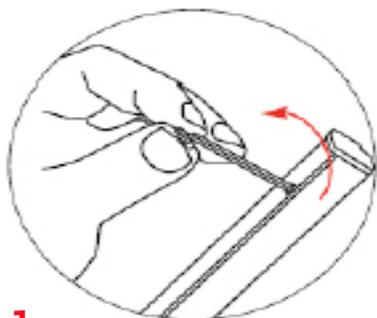
**1.** En utilisant la clé Allen rangée sous le carter, desserrer les vis du rail supérieur. Faire pivoter l'embout du rail afin de faire apparaître la glissière en aluminium.
